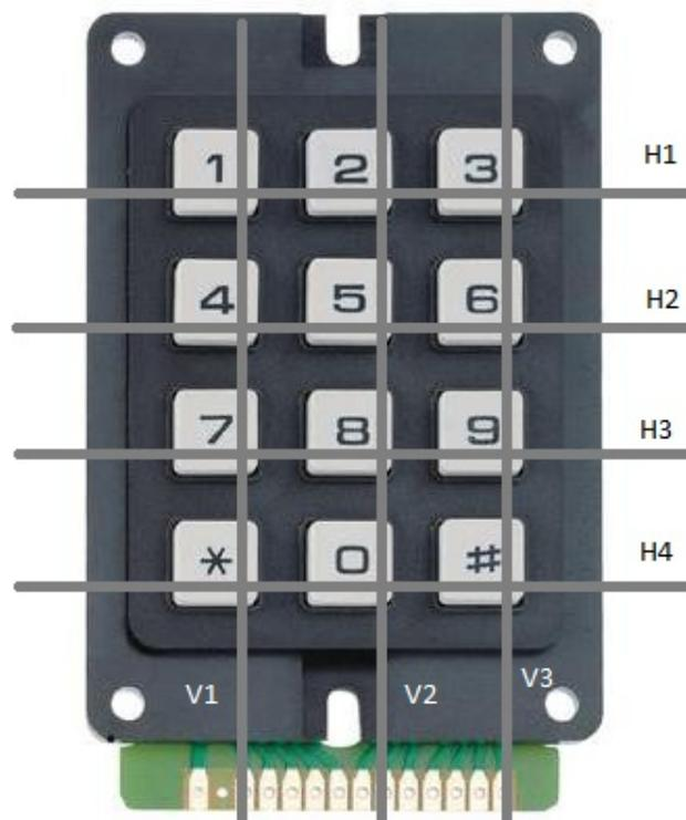
Abbildung 4: Drucktastenfeld mit Kennzeichnung der Spalten und Zeilen
